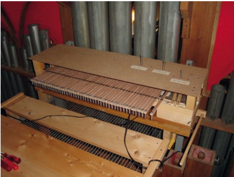
Die MIDI-Koppel, eingebaut mit Schutzabdeckung und den drei Schaltern für Oktavierung (statt 8'-Lage 16' oder 4'), Hall und Anschlagsdynamik. Ganz rechts der Rundstab liegt waagrecht, die MIDI-Koppel ist somit eingeschaltet.
